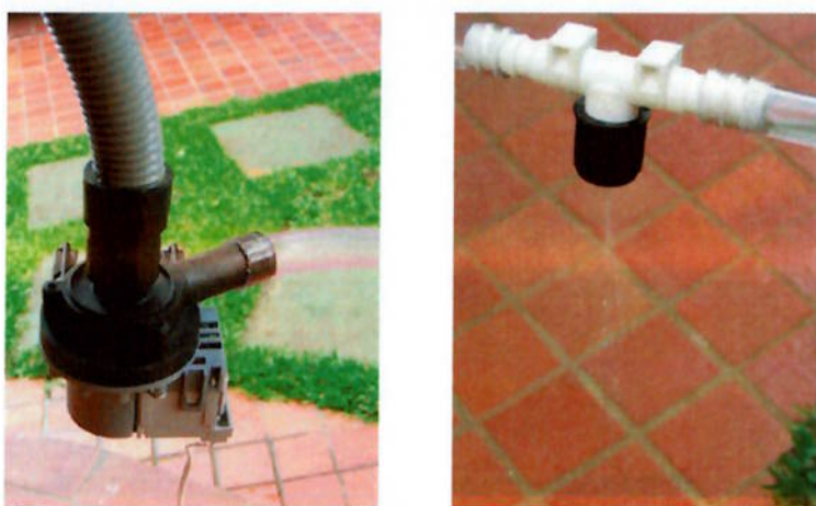
Figura 54 – Teste – bomba utilizada e ineficiência de pressão
