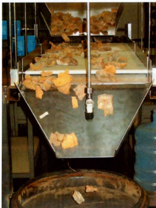
Figura 55 – Teste da Esteira e do Vibrador
