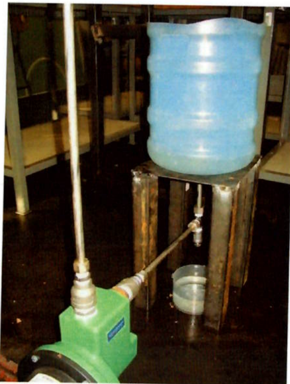
Figura 76 – Bomba com detalhe da localização do reservatório
