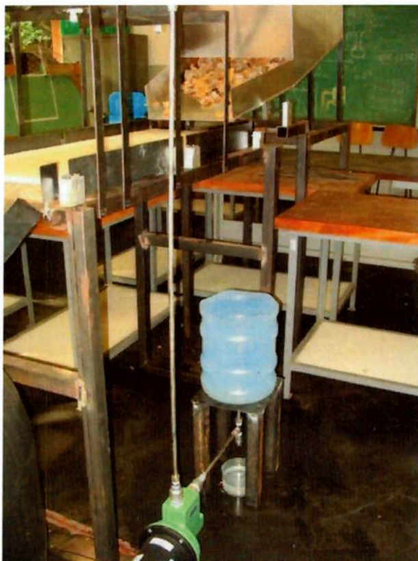
Figura 83 – Estrutura final com localização de bomba e reservatório
