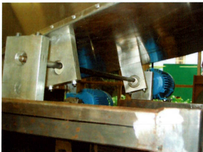
Figura 70 – Detalhe do eixo excêntrico com a localização dos quatro mancais
