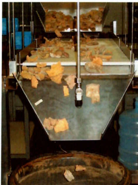
Figura 67 – Lascas sendo depositadas no container
