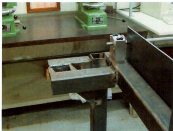
Figura 56 – Detalhe do apoio do motor da esteira e mancal 1
