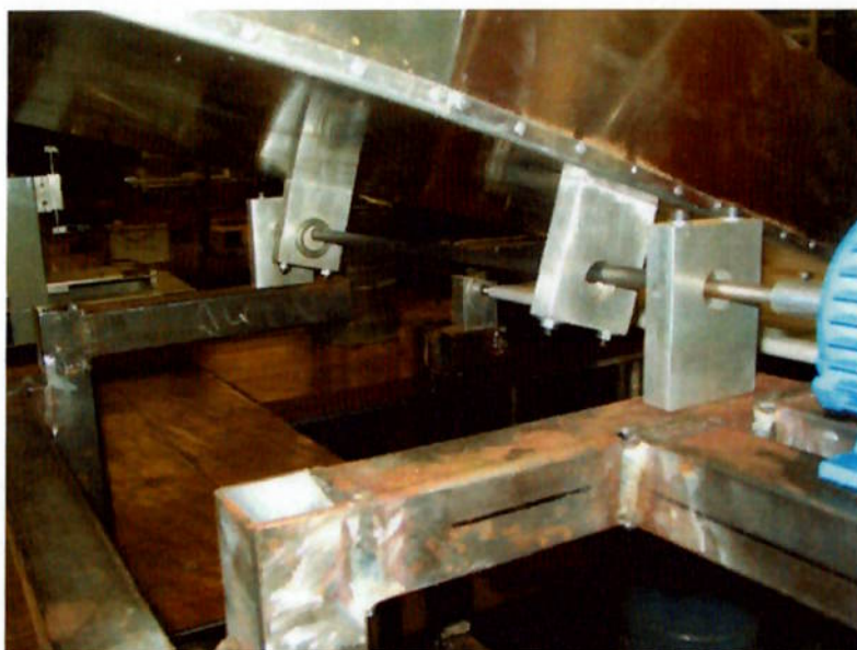
Figura 69 – Detalhe do eixo excêntrico com a localização dos quatro mancais 1
