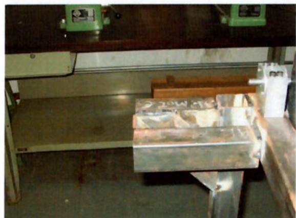
Figura 57 - Detalhe do apoio do motor da esteira e mancal 2
