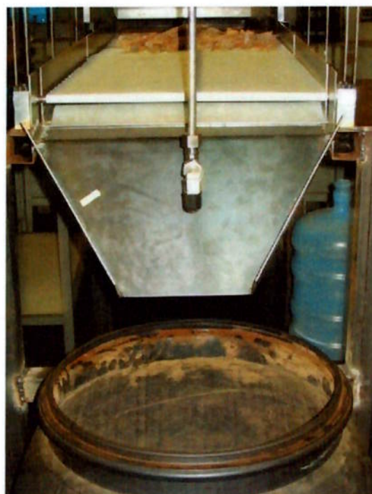
Figura 64 – Depósito das lascas com bocal na parte superior
