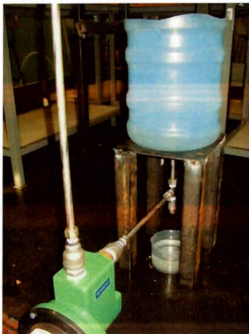
Figura 45 – Suporte e localização do reservatório
