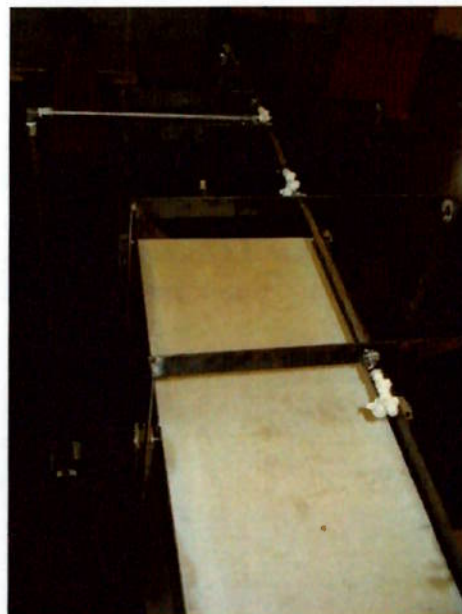
Figura 63 – Vista superior da esteira com barra de pulverização
